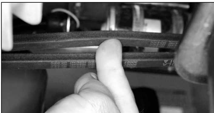
Fig. 8 - Comprobación de la tensión de la correa
