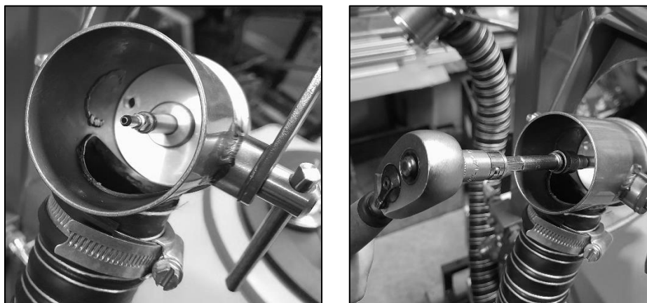
Fig. 13 - Extracción de la boquilla de alimentación del atomizador
