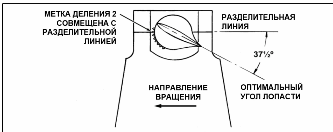
Рис. 4 – Метки настройки на лопасти
