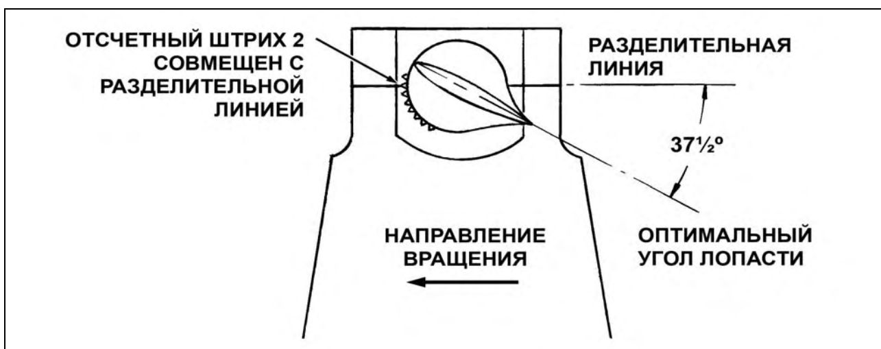
Рис. 4 – Регулирующие метки на лопасти
